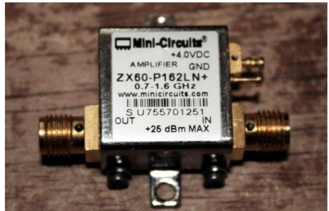
Figure 7 ZX60-P162LN+ LNA module
